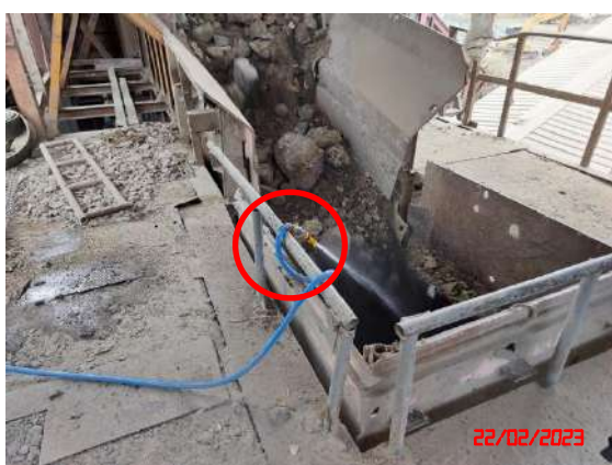
ระบบเปลี่ยนน้ำบริเวณแหล่งกำเนิดฝุ่นละออง
